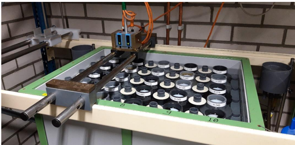
Figuur 2.4: Open permeameter in een falling head opstelling met meetbrug en afstandslasers. De witte oppervlakken in en naast de monsterhouders zijn kunststof laserreflectoren die op het water drijven. Met behulp van deze reflectoren wordt het stijghoogteverschil over het monster gemeten door de twee afstandslasers.
