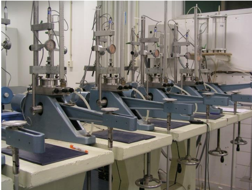
Figuur 2.3: Laboratoriumopstelling voor doorlatendheidsmetingen in een aangepaste oedometer.
