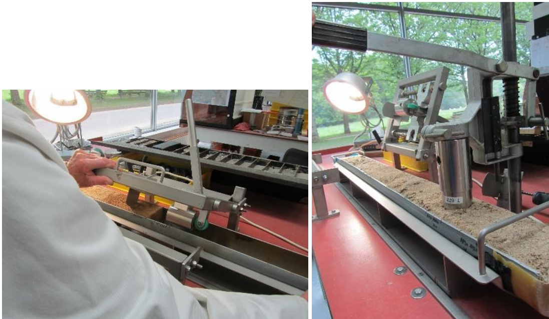
Figuur 3.1: Uitname van niet-cohesieve monsters uit een steekern. Links: trekbeugel, voor bepaling van de verticale doorlatendheid. Rechts: hefboom, voor bepaling van de horizontale doorlatendheid.
