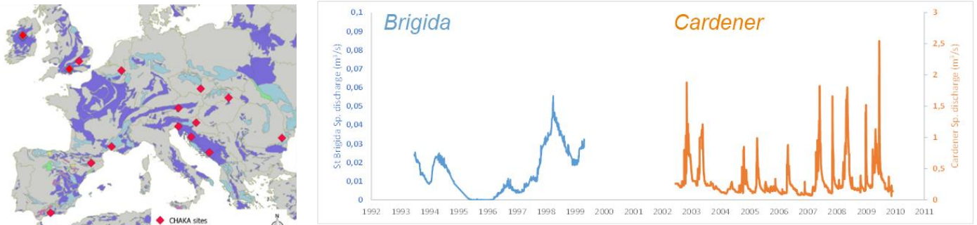
Figuur S1: De St. Brigidabron als één van de pilots in het project CHAKA. Ten opzichte van een andere pilot in een typisch Chalk-gebied (de Cardener spring in het VK) vertoont het debiet van de St. Brigida een veel tragere reactie (rechter diagrammen).
